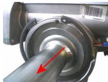
4) Alignez soigneusement les marques de référence en tournant l'axe si nécessaire. Retirez le capteur en agissant dans la partie inférieure avec un tournevis ou un outil similaire.
