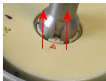
5) Faites très attention au nouveau capteur : le clip de retenue doit être parfaitement orthogonal à la structure plastique afin de rendre les deux « disques » du capteur solidaires.
