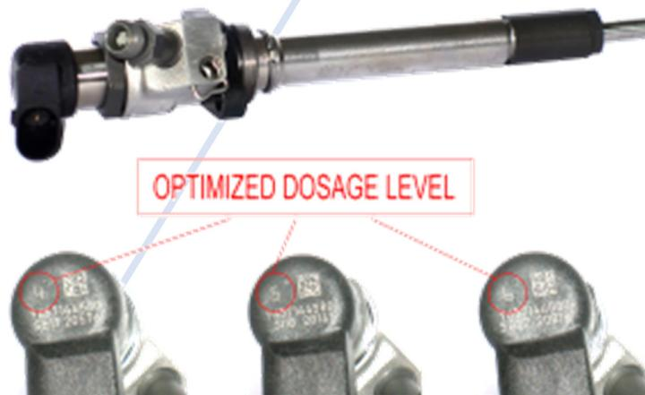
Les chiffres entourés en rouge servent à identifier le degré optimal de dosage de carburant. Des valeurs différentes peuvent provoquer des déséquilibres et des irrégularités dans le fonctionnement du moteur et dans la gestion des gaz d'échappement.
